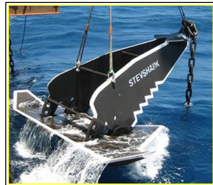
Abb. 2-3: Stevshark-Anker für steinige Böden
